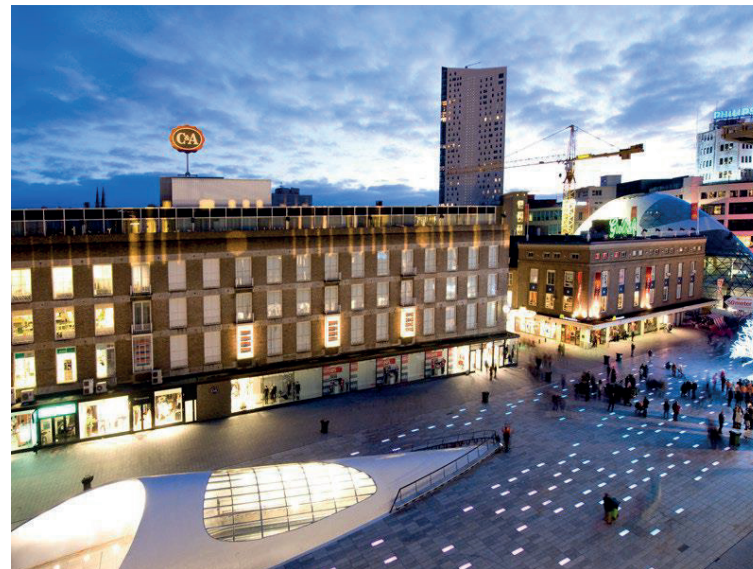
Ontwerp van Petra Hulst, Signify, waarbij de verlichting van de parkeergarage gebruikt is om het plein erboven te verlichten
