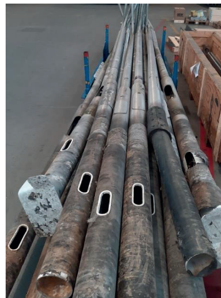
De foto's hierboven tonen een voorbeeld van 'repair en refurbish in het project Assen'. Afgedankte lichtmasten worden opgeknapt en opnieuw gebruikt (foto's van Montad).
