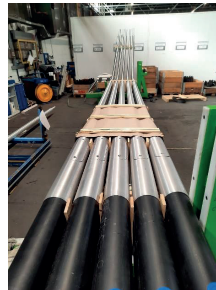
De foto's hierboven tonen een voorbeeld van 'repair en refurbish in het project Assen'. Afgedankte lichtmasten worden opgeknapt en opnieuw gebruikt (foto's van Montad).
